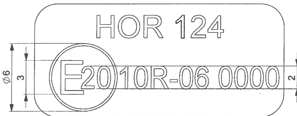
Rys. 11: Rysunek przykładowego znaku homologacji
